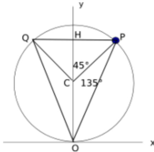
il triangolo  $OQP$  è isoscele, il triangolo  $CHP$  è rettangolo isoscele, per cui  $CH$ , lato del quadrato di diagonale  $CP$ , è  $CH = \frac{3.00\text{ m}}{\sqrt{2}} = 2.12\text{ m}$  e l'altezza  $OH = 3.00 + 2.12\text{ m} = 5.12\text{ m}$ . Inoltre, osservando che  $CH = HP$ , si può ricavare  $OP$  con il th. di Pitagora
