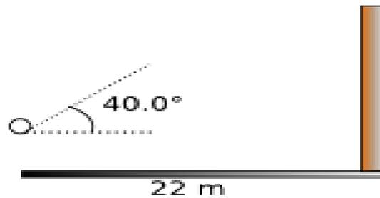
Caso 1. (a): il tempo di volo prima di colpire il muro è quello durante il quale la palla percorre i 22.0 m che la separano dal muro stesso. Calcoliamo prima le componenti della velocità
