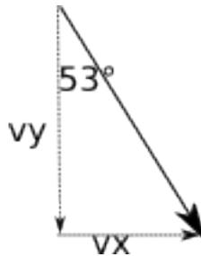
**Soluzione.** nell'istante in cui il proiettile viene sganciato la velocità dell'aereo e del proiettile solidale è quella illustrata in figura. Pertanto il proiettile, mentre percorre in caduta i  $730 \text{ m}$ , verrà accelerato verso il basso dal suo peso incrementando così la sua velocità verticale iniziale, secondo la legge del moto uniformemente accelerato
