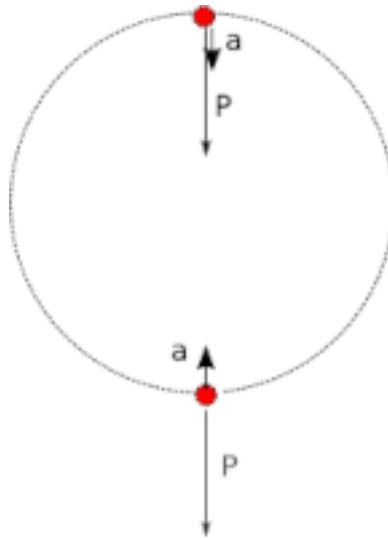
**Soluzione.** La figura mostra lo schema vettoriale delle due accelerazioni in gioco. quando il corpo si trova in alto, la sua accelerazione di gravità è ridotta dalla forza centripeta; viceversa, quando è nel punto più basso, il suo peso è aumentato dalla accelerazione centripeta. Sapendo che nel punto più alto, lo studente ha una riduzione del suo peso pari ai  $\frac{5}{6}$ , possiamo scrivere
