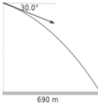
**Soluzione.** Indichiamo con  $v$  la velocità dell'aereo e quindi anche del bersaglio ad esso solidale. Possiamo pertanto calcolare la componente orizzontale di tale velocità, conoscendo l'angolo.
