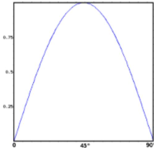
dalla quale si osserva che il valore massimo si ottiene per l'angolo di  $45^\circ$ . L'alzo deve essere minore di  $90^\circ$ , tiro verticale, e osservando la simmetria della curva si può ricavare che per due angoli complementari, cioè che sommati danno  $90^\circ$ , il valore della funzione seno è lo stesso e ciò determinerà una uguale gittata.
